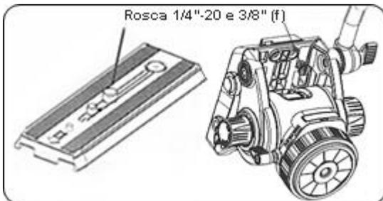
Para remover a placa de engate rápido, destrave a alavanca (e) e pressione o botão de segurança (l). Fixe a placa na base da câmera apertando o parafuso e encaixe novamente no sentido conforme mostra a figura (a). Posicione para obter o melhor equilíbrio e trave a alavanca (e).
