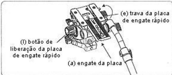
Para remover a placa de engate rápido, destrave a alavanca (e) e pressione o botão de segurança (l). Fixe a placa na base da câmera apertando o parafuso e encaixe novamente no sentido conforme mostra a figura (a).
