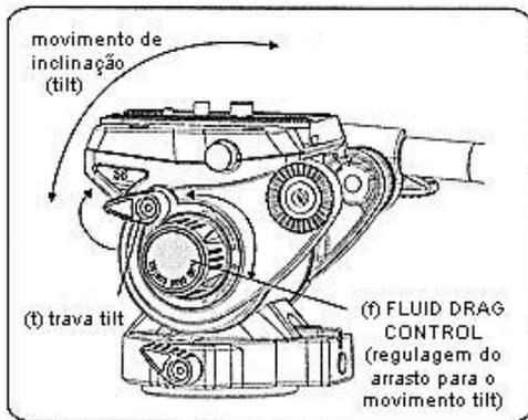
**Ajuste de tilt:** gire a alavanca lateral (t) no sentido anti-horário para liberar o movimento de inclinação vertical e ajuste o botão de regulagem "fluid drag control" (r) com a câmera montada na cabeça, para encontrar a tensão mais adequada.
