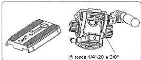
A placa de engate rápido vem com parafusos de rosca 1/4" e 3/8". O parafuso que não estiver sendo usado pode ser fixado por baixo da parte superior da cabeça (f).
